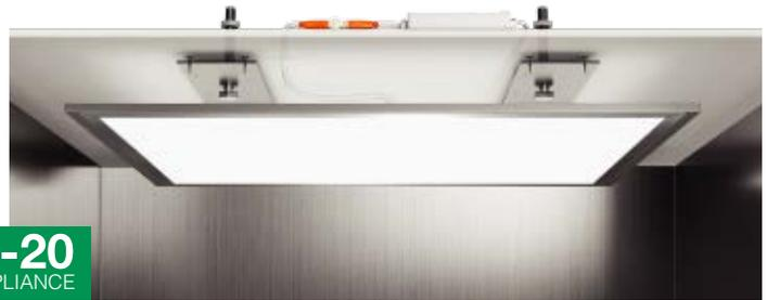
Das CCT LED-Paneel von WECO ist eine attraktive und moderne Kabinenbeleuchtung. Mit einer Aufbauhöhe von nur 10 mm kann es in jeden Lift eingebaut werden, ohne den verfügbaren Kopfraum zu beeinträchtigen. Mithilfe der mitgelieferten Fernbedienung kann die Farbtemperatur und Lichtstärke in Abstufungen von 10% angepasst werden.
